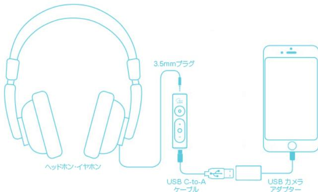
iPhone に Lightning - USB カメラアダプターを接続し、市販の USB A-to-C ケーブルや、USB A-to-C 変換アダプター等で SXFI AMP と接続します。
