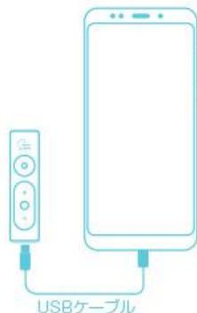
USB Type-C ポート搭載の Android スマートフォンの場合は、USB C-to-C ケーブルを利用してスマートフォンと SXFI AMP を接続します。
